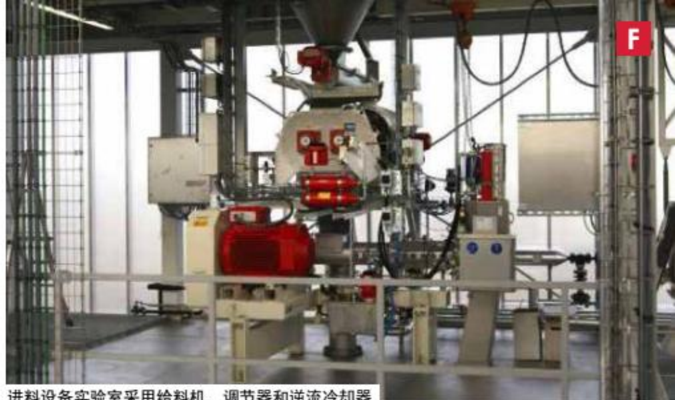
进料设备实验室采用给料机, 调节器和逆流冷却器
