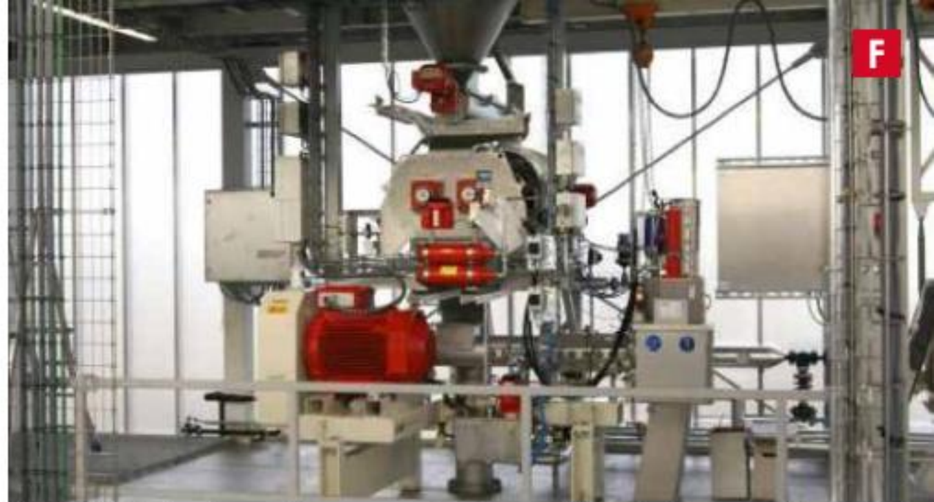
Línea de Peletizado con Expansor equipado con Alimentador, acondicionador y Enfriador a Contraflujo del Laboratorio de Diseño de Alimentos
