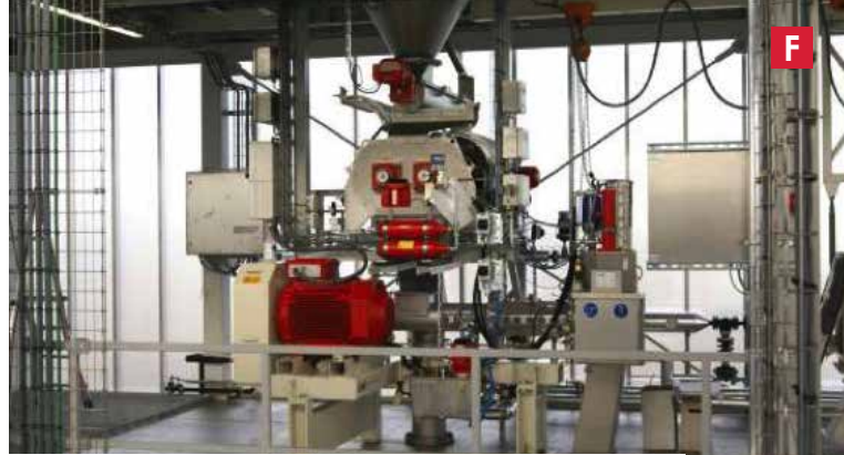
Ligne de granulation d'expansion équipée d'un alimentateur, d'un conditionneur et d'un refroidisseur pris chez Feed Design Lab
